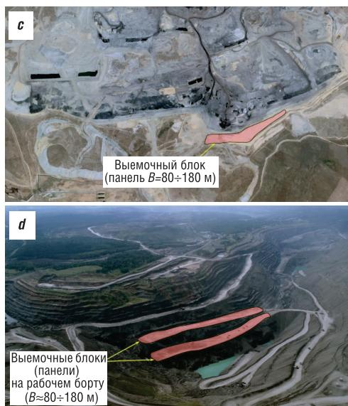
**Рис. 1. Примеры панельной отработки рабочего борта:**
