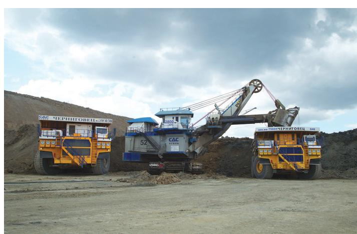
Рис. 8. Погрузка вскрышных пород экскаватором Р&Н 2800 ХРС при двух подъездах автосамосвалов БелАЗ-7560 (разрез «Черниговский»)
