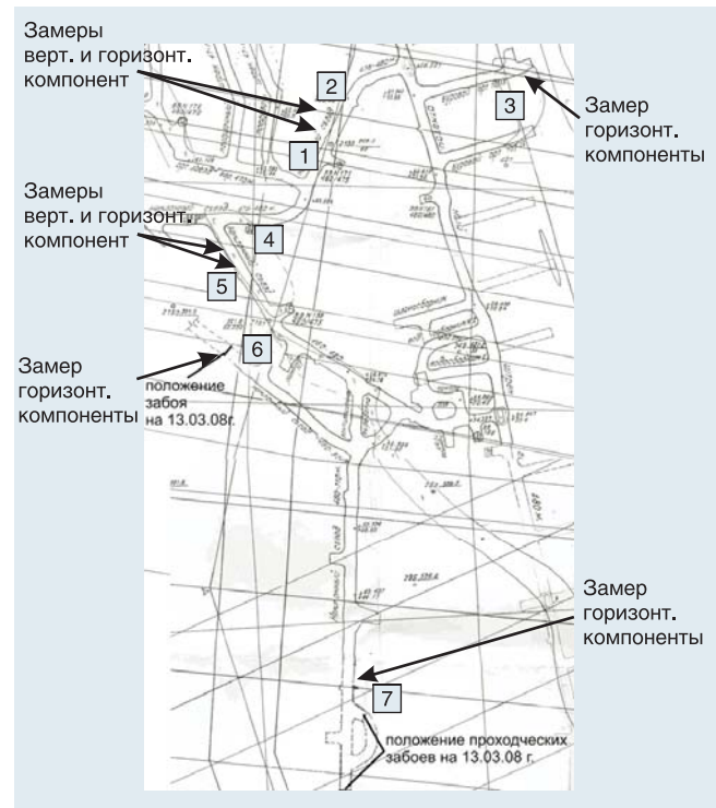
Рис. 2. Фрагмент плана гор. 480 м Учалинского рудника с обозначением мест замеров напряжений (цифры 1-7 в квадратах)
