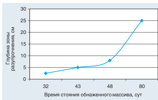
Рис. 4. Динамика процесса разупрочнения приконтурного массива
