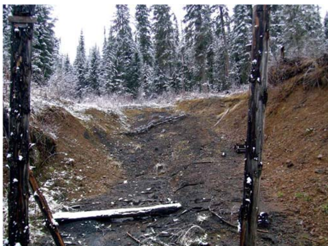
Сейбинское месторождение марганца. Разведочная траншея, в которой производился отбор технологической пробы (Источник: http://mirpoao.eltegra.ru/projects/geo/memo.asp )
