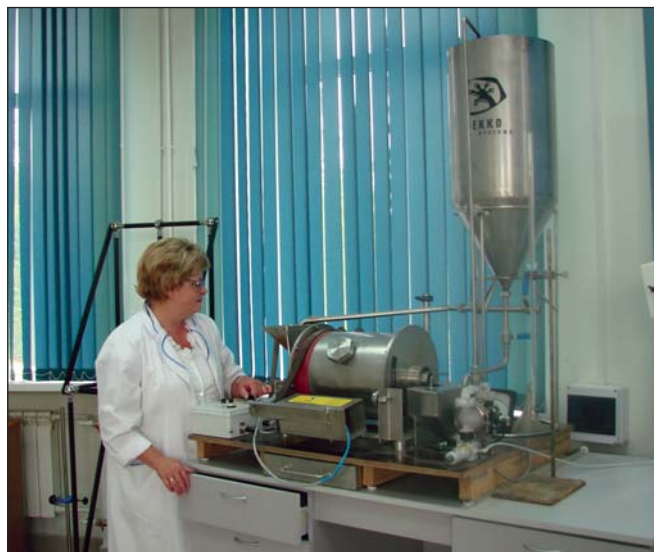
Установка интенсивного цианирования гравико-концентратов Gekko
